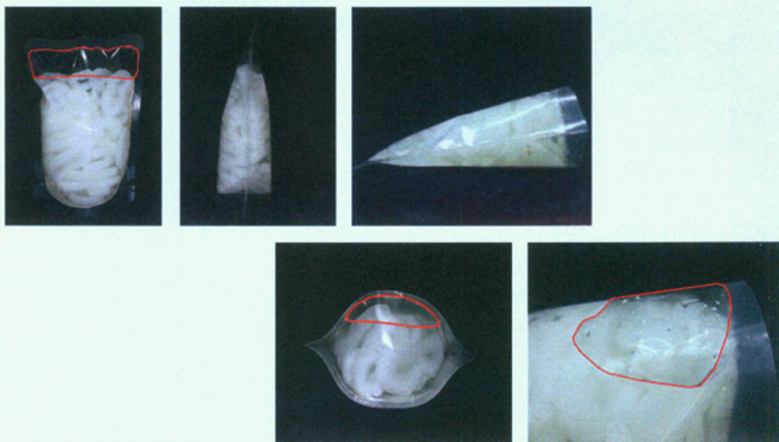
ภาพที่ 19 ทดลองบรรจุอาหารในบรรจุภัณฑ์อ่อนตัวแบบโปร่งใสเพื่อสังเกตการจมน้ำของชิ้นอาหารในของเหลว
