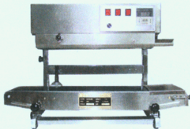
ภาพที่ 8 เครื่องปิดผนึกแบบอัตโนมัติให้ความร้อน 2 ด้าน
