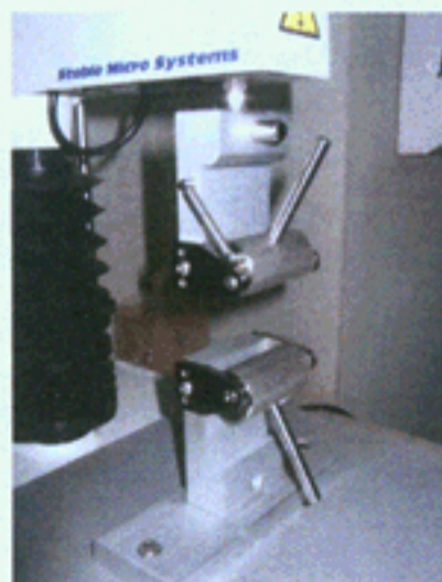
ภาพที่ 7 เครื่องทดสอบและจุดที่ทำการทดสอบความแข็งแรงของรอยปิดผนึก
