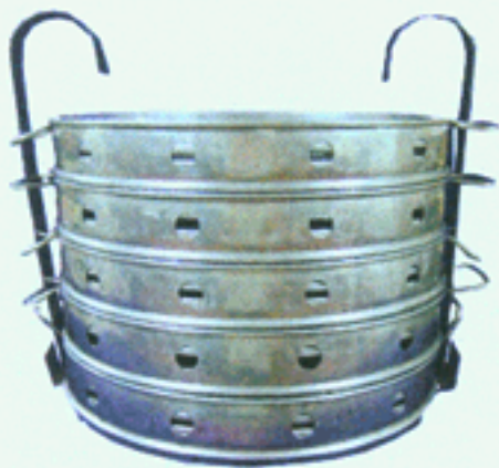
ภาพที่ 15 อุปกรณ์แบบเก่า ซึ่งต้องใช้ ตะขอกีเยวอุปกรณ์ขึ้นหลังจากการ ต้มฆ่าเชื้อผลิตภัณฑ์แล้ว
