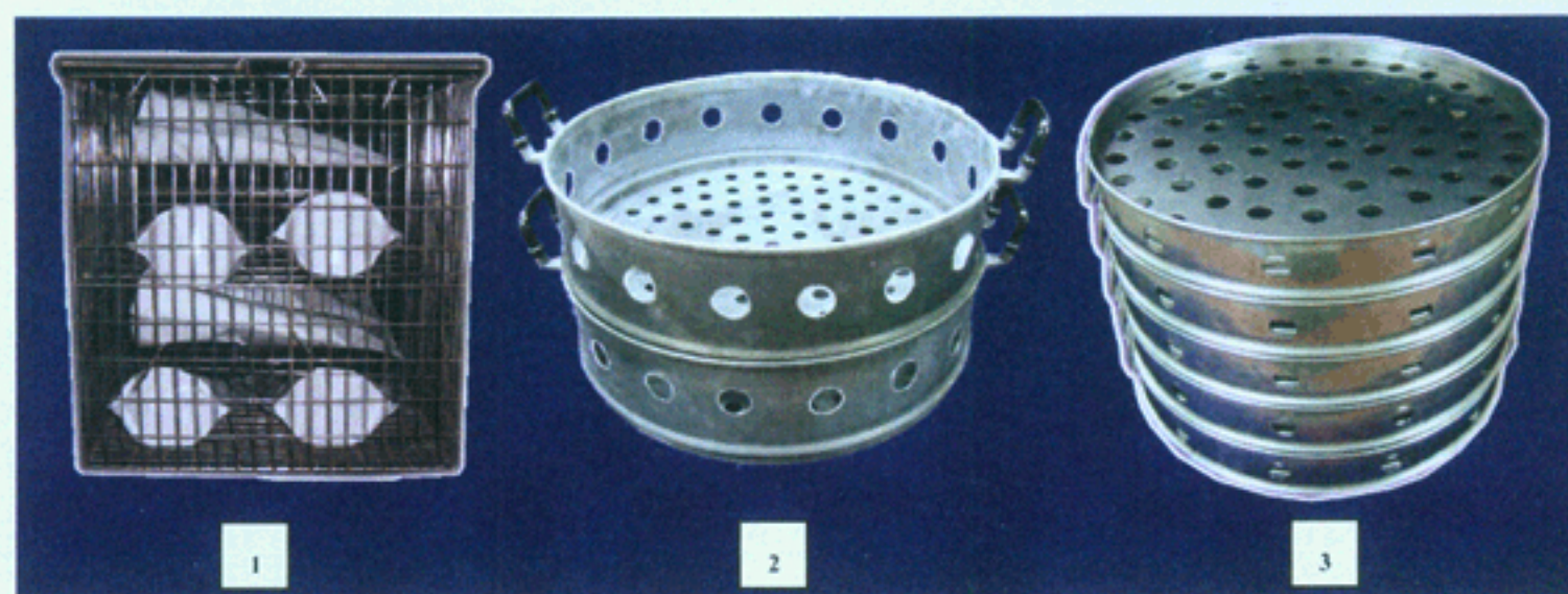
ภาพที่ 9 อุปกรณ์สำหรับเรียงบรรจุภัณฑ์อ่อนตัว แบบที่ 1, 2, และ 3
