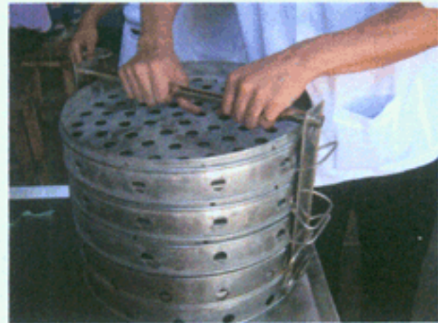
ภาพที่ 16 อุปกรณ์แบบใหม่ ใช้ด้ามจับ สอดกับหูหิ้วทั้ง 2 ข้าง โดยไม่ต้องใช้ ตะขอกีเยว
