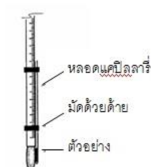
รูปที่ ๕ วิธีการมัดหลอดแคปิลลารีกับเทอร์โมมิเตอร์
