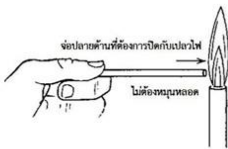
รูปที่ ๓ วิธีการปิดปลายหลอดแคปิลลารีด้วยเปลวไฟ
