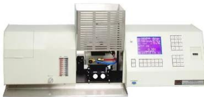
ภาพที่ 4 เครื่องทดสอบโลหะ Atomic Absorption Spectrometer
