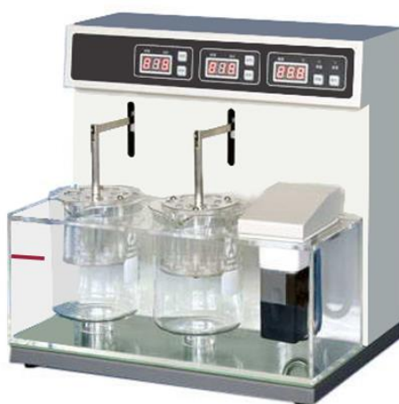
ภาพที่ 8 แสดงเครื่องทดสอบ Disintegration test สำหรับใช้ทดสอบการกระจายตัวของยาเม็ดและแคปซูล
