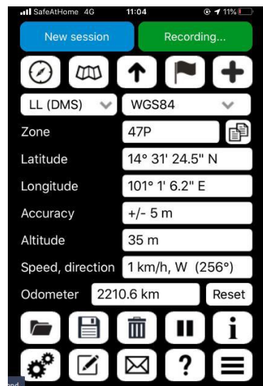
ภาพที่ 12 ภาพตัวอย่างแอปพลิเคชันในการวัดค่าพิกัด
