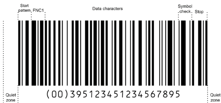
แผนภาพที่ 2-5 แสดงตัวอย่างโครงสร้าง GTIN-128 barcode
