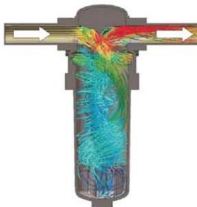
ภาพที่ ๑๕ กระบวนการแยกน้ำและอากาศในไส้กรอง
